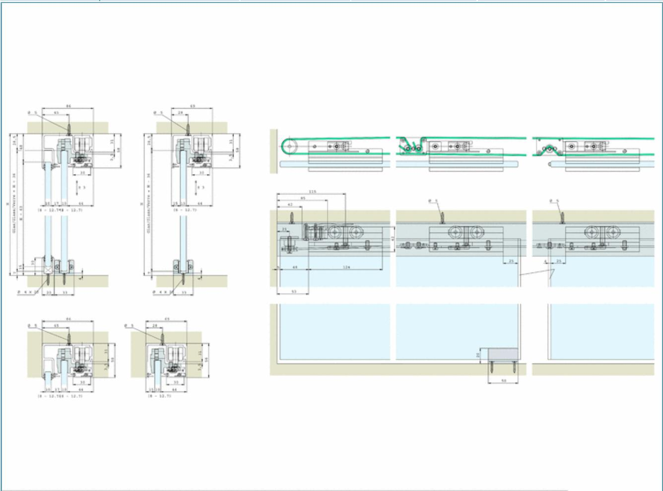
System für 2 synchronlaufende Glastüren mit Kevlarseil zu mod. GW / GWF
